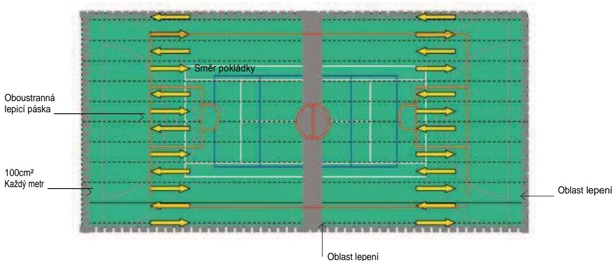
Doporučujeme dvousložkové epoxidové lepidlo, lepidlo GreenLay, referenční složka A 1551057 složka B 1551058 - množství, které se aplikuje tenkou ozubenou špachtlí je mezi 300 a 350 gr / m<sup>2</sup>. Pro správnou instalaci je třeba pečlivě dodržovat doporučení výrobce, zejména dobu čekání před položením podlahové krytiny. Poté je nutno odstranit vzduchové bubliny, které se mohou nacházet mezi podlahou a podkladem.
